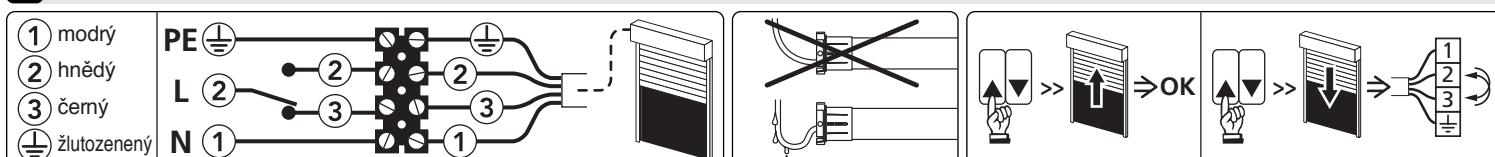
⚠ - Je možné zapojit nejvýše 3 motory v paralelním zapojení na jeden přepínač.
