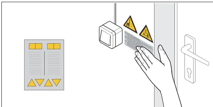
III. 1.1 Poser l'autocollant à proximité du dispositif de réglage ou de commande fixe
