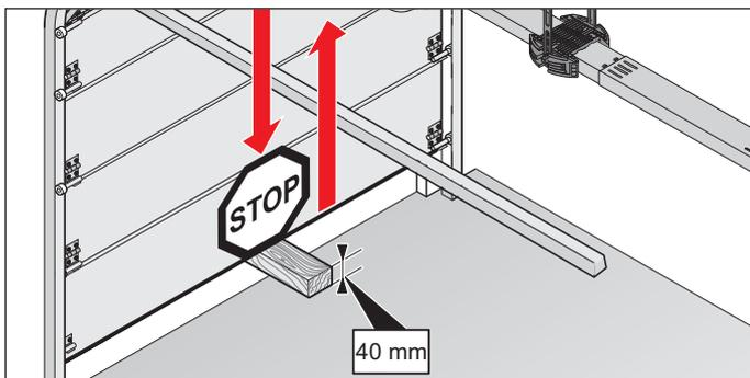
III. Exemple : détection d'obstacle sur porte sectionnelle
