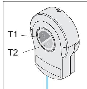
III. Touches à effleurement T1 et T2 de la commande murale
