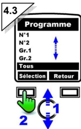
Choisir le canal ou le groupe à programmer. Si vous sélectionnez "tous" (comme dans l'exemple), les horaires d'ouverture et de fermeture programmés s'appliqueront à l'ensemble des moteurs appairés à l'horloge.
