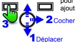
Déplacer le curseur sur un canal à ajouter puis cocher en bougeant le joystick à droite ou à gauche (N°1 sur l'exemple).
