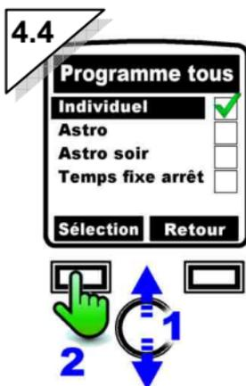
Positionner le curseur sur le mode de programmation souhaité puis cocher en bougeant le joystick à droite ou à gauche.
