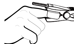
Fig.3-2colocación del sensor
