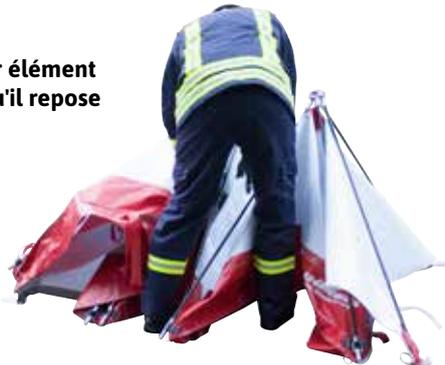
4. Pousser sur le point de tension central pour le tendre. L'élément est alors maintenu tendu.
