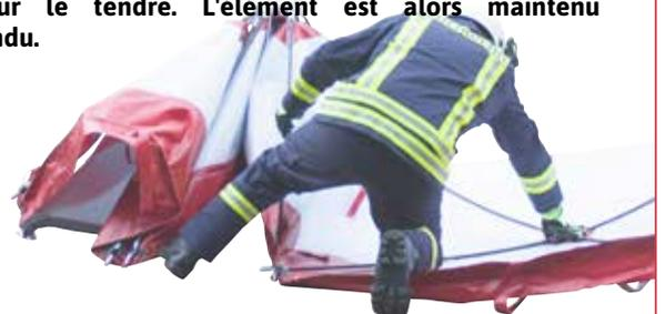
5. Redresser le premier élément et déplier le second en répétant les étapes 3 et 4. Poser le pied sur la languette rouge qui se situe au sol en bas de la bande rouge et pousser sur le point de tension centrale de façon simultanée jusqu'à ce que le point de tension ressorte vers l'extérieur pour tendre la bâche.
