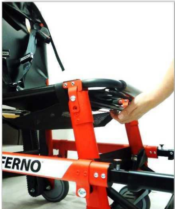
Tirez le câble rouge du dessous de l'assise vers l'extérieur.
