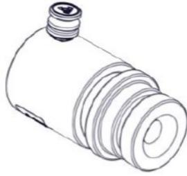
Connecteur à ressort. Le connecteur à ressort (figure 1-26) a été développé pour être utilisé avec les jambes de force LockStroke. Le connecteur permet le positionnement précis d'une jambe de force LockStroke sur une surface non flexible et maintient la compression de la jambe de force même en cas de léger mouvement. Un ressort hélicoïdal d'une longueur de course d'environ 1,2 cm (1/2") est utilisé pour compenser l'espace entre les rainures de verrouillage sur la jambe de force LockStroke.
