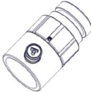
Connecteur fileté ajustable. Le connecteur fileté ajustable (figure 1-27) a été développé pour être utilisé avec les jambes de force LockStroke dans des conditions où tout mouvement violent pourrait être dangereux. Le connecteur permet le positionnement final "en douceur" d'une jambe de force LockStroke sur une surface non flexible. Une extension filetée de 1,2 cm (1/2") est utilisée pour ajuster et compenser finement l'espace entre les rainures de verrouillage et la jambe de force LockStroke.
