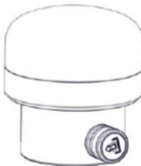
Base de caoutchouc 4". La base en caoutchouc 4" (figure (1-9)) est une base standard avec un capuchon en caoutchouc de 4", utilisée pour stabiliser les supports lorsque la surface d'appui est lisse mais ne peut être percée. La base en caoutchouc 4" est équipée d'un œillet en laiton pour l'abaissement/le positionnement.
