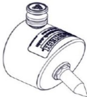
Base du cône de compensation. La base du cône de décalage (figure 1-8) est un moyeu à sommet angulaire avec un cône en acier fileté perpendiculaire à la face. Un côté du cône sera vertical et pourra être appliqué très près d'un côté choisi. La surface inclinée du moyeu servira de surface d'arrêt pour empêcher une pénétration excessive.
