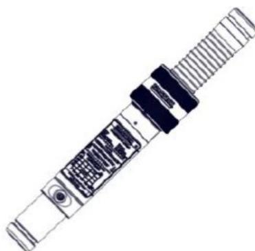
La jambe de force extensible LockStroke se verrouille automatiquement par incréments de 1 cm sans qu'il soit nécessaire d'insérer manuellement une goupille de verrouillage. Cette caractéristique permet d'étendre et de verrouiller le système de support LockStroke à distance. Le verrouillage mains libres se fait par l'intégration d'un accouplement à double rangée de billes. La résistance à l'écrasement axial du support dépasse les 22 680 kg.
