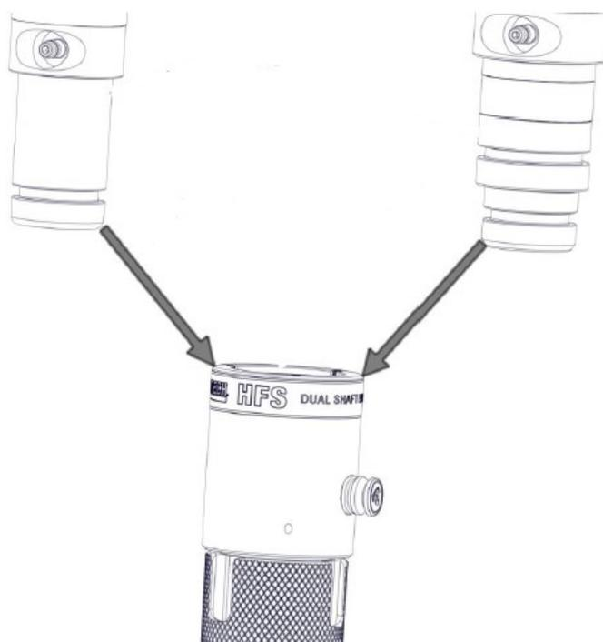
4. Pour maximiser l'efficacité et la sécurité du levage hydraulique, **toujours positionner le HFS à un angle de 60°- 80°** ou plus par rapport au sol et à l'objet soulevé. Les barres de stabilisation doivent toujours être installées en premier et utilisées en renfort à un angle **de 45° à 55°** par rapport au sol et à l'objet soulevé.
