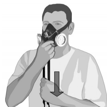
(3) Tirez les sangles vers le bas jusqu'à ce que le masque soit fermement ajusté.
