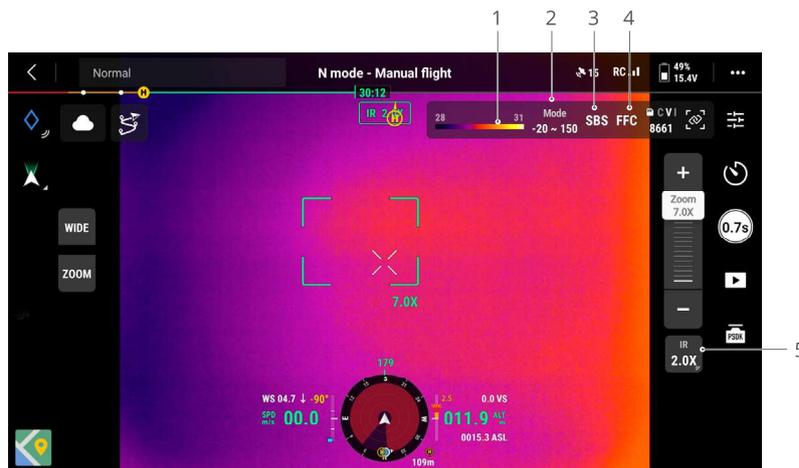
1. **Palette** : affiche les valeurs de mesure de température les plus élevées et les plus basses de la vue actuelle. Appuyez pour choisir entre différentes palettes de mesure de la température infrarouge, ou activez l'isotherme pour définir les intervalles de mesure de la température. Veuillez noter que si la zone mesurée dépasse les valeurs de mesure de température maximale ou minimale de la vue actuelle, le réglage ne prendra pas effet.
