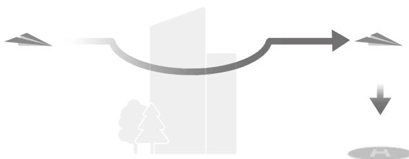
2. **Optimal** : quelle que soit l'altitude RTH réglée, l'appareil prévoit automatiquement la trajectoire RTH optimale et ajuste l'altitude selon les facteurs environnementaux comme les signaux de transmissions et les obstacles. La trajectoire de RTH optimale signifie que l'appareil emprunte la distance la plus courte possible, afin de réduire la quantité d'énergie utilisée par la batterie et d'augmenter le temps du vol.
