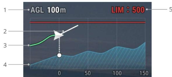
1. Altitude au-dessus du sol (AGL) : indique l'altitude de l'appareil par rapport au sol.
