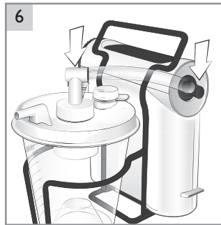
6 Vérifiez que tous les branchements des tubes à vide sont bien fixés.
