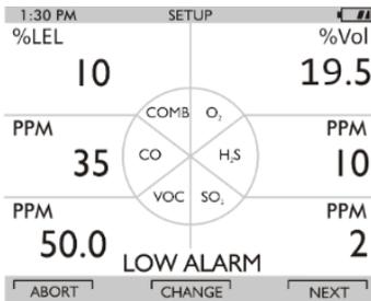
Fig. 8 Réglage de l'alarme de la cellule
