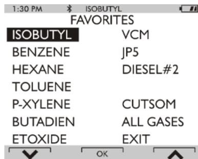
La valeur maximale est calculée en multipliant la plage de la cellule par le RF. Par exemple, la valeur max. pour l'hexane est  $2000 * 4,5 = 9000$  ppm. La valeur maximale ne peut pas dépasser 9999 ppm.
