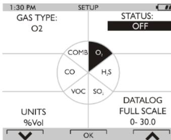
Fig. 10 Configuration des options de la cellule
