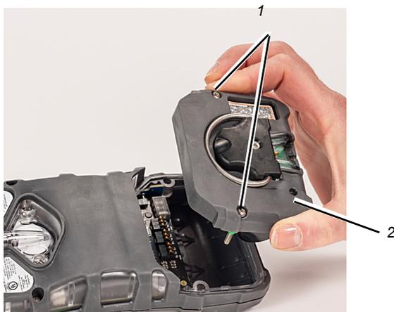
Fig. 12 Remplacement de la batterie
