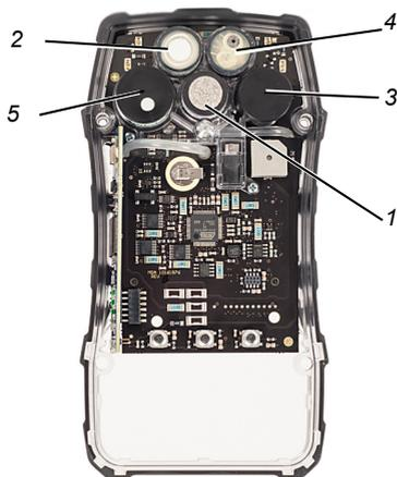
Fig. 13 Positions possibles pour le remplacement de la cellule
