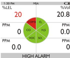
Fig. 6 Niveaux d'alarme (ici Alarme haute)
