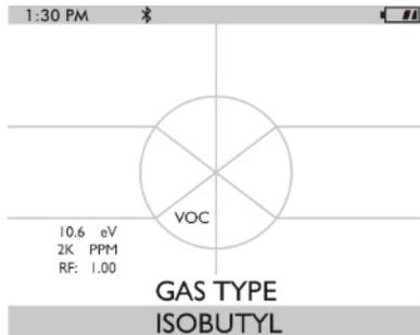
Pendant les opérations, le RF peut être affiché par le biais de plusieurs menus. Si l'option Activer menu est activée, utiliser le bouton ▼ sur la page Mesure principale pour faire défiler les options du menu et sélectionner OUI pour "Changer Gaz VOC ?". En cas de sélection d'un gaz sur cette page, le nom du gaz à 8 caractères est affiché, ainsi que le facteur de réponse, la valeur maximale du gaz COV et les valeurs actuelles des alarmes haute et basse.
