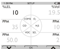
Fig. 9 Réglage de l'alarme de la cellule
