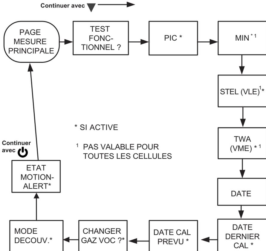
**Test fonctionnel (Bump) (page TEST DE FONCTION)**
