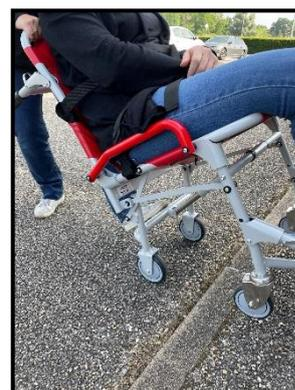
D - 3 Franchir un petit obstacle : trottoir par exemple. Poser un pied sur la barre de basculement arrière, tirer légèrement la chaise vers soi pour soulever les roues avant.
