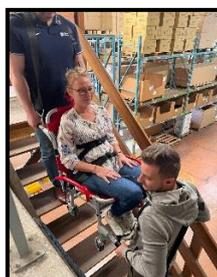
E - 3 Lors de la montée ou la descente des escaliers, l'opérateur à l'avant du patient doit se positionner sur les marches du bas. L'opérateur à l'arrière du patient doit se placer sur les marches du haut.
