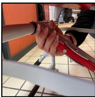
C - 2 Appuyer sur le compas de verrouillage sous l'assise de la chaise
