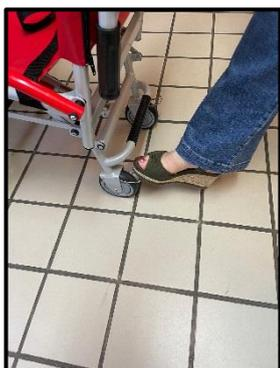
D - 1 Opérateur 1 : Bloquer les roues arrière à l'aide des freins et tenir fermement les poignées arrière.
