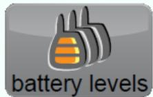
« **battery levels** » donne accès aux niveaux des piles des capteurs sans fils connectés. L'icône ne s'affiche que si au moins un capteur sans fils est connecté au **LEADER Search**.
