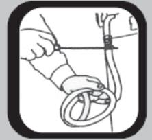
Le raccordement à la cuisinière doit se faire du même côté que le point d'alimentation, de façon à ce que le tuyau ne croise pas l'arrière de l'équipement. Au besoin, changez l'admission de gaz ou demandez l'assistance technique d'un adaptateur de tuyau, pour que l'entrée de gaz se fasse du bon côté
