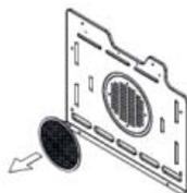
Pendant la cuisson, installez le capot de filtre pour réduire la pénétration de graisse/débris dans le ventilateur.
