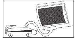
■ Utilisez de préférence des produits nettoyants universels à base d'agents tensio-actifs (savon, ...) et un chiffon type microfibrés. Pour un simple dépoussiérage, un chiffon suffit. L'entretien doit être effectué hors tension et après que l'appareil a refroidi.
