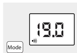
**i** En cas d'absence prolongée, l'appareil diminue progressivement sa consigne de température. Lorsqu'il détecte une présence, il réagit et revient dans le mode de fonctionnement défini par l'utilisateur.
