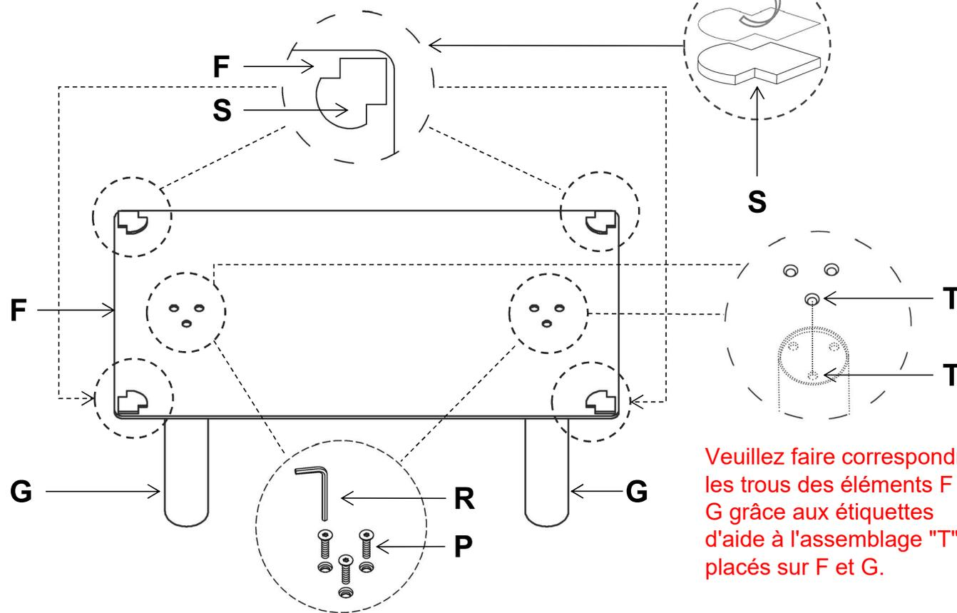
Veuillez faire correspondre les trous des éléments F et G grâce aux étiquettes d'aide à l'assemblage "T" placés sur F et G.
